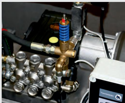
Dettaglio pompa: accoppiamento con giunto elastico,
