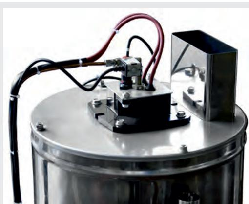
Testa di combustione tipo E: ugello gasolio, elettrodi di accensione, connettori alta tensione, tubo gasolio in acciaio ramato, controllo fiamma, elettrovalvola gasolio, camino fumi.
