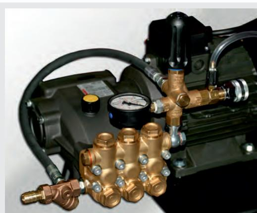
Vista generale interna: pompa, valvola di regolazione, filtro alimentazione, iniettore detergente, tubo by-pass, entrata bassa pressione, uscita alta pressione.
